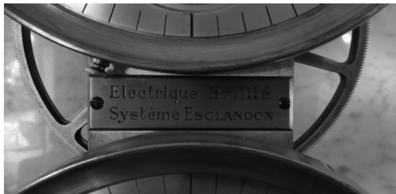
Fig.2 – La roue dentée d'asservissement du temps moyen au temps sidéral, en partie visible derrière les deux cadrans.
