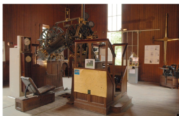
Le cercle méridien de 19 cm d'ouverture et 2,35 m de distance focale de l'observatoire de Toulouse Crédit : Michel ESTEVES. SAP. ©
