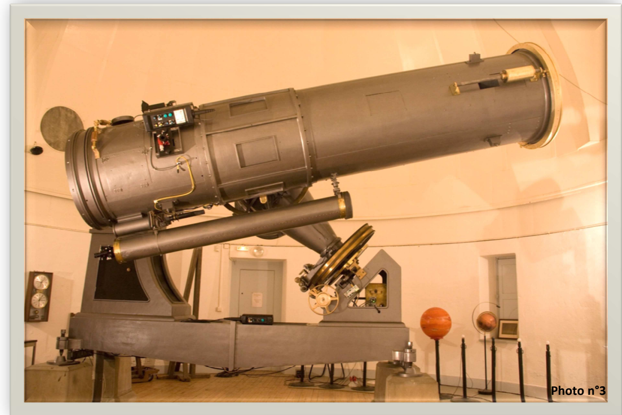
Le télescope actuel de 0,80 m d'ouverture et 10,80 m de distance focale. (Avec sa nouvelle motorisation).
