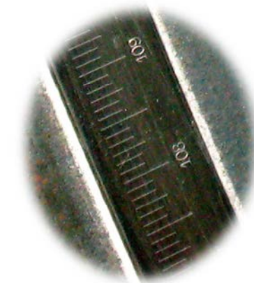
Détail du limbe d'un cercle. Une graduation vaut 5' d'arc.
